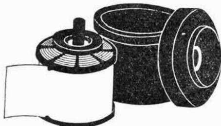
Fig. 2. — Vaschetta con scanalatura a spirale.
