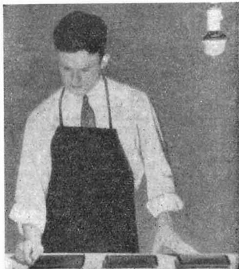
Fig. 18. — Per le operazioni di sviluppo, arresto e fissaggio sono necessarie tre bacinelle distinte.
