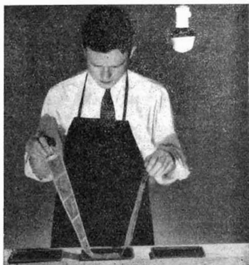
Fig. 16. — Trascorsi i dieci minuti, passeremo la pellicola nel bagno di arresto.
